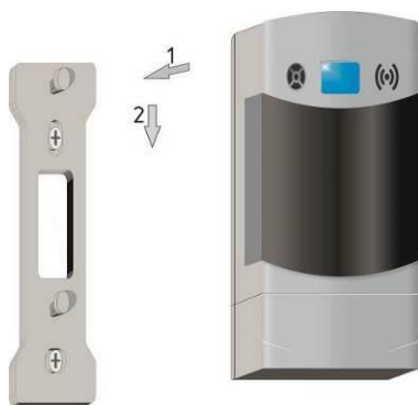
Рисунок Г.2 – Установка БСУ на монтажную панель
