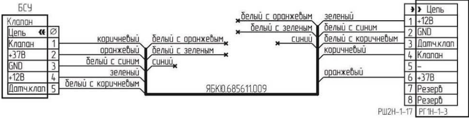
Рисунок А.4 – Схема подключения клапана КЗГЭМ-У с разъемом РГ1Н-1-3.
