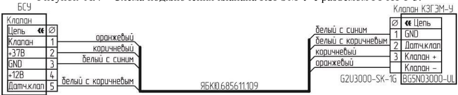
Рисунок А.5 – Схема подключения клапана КЗГЭМ-У с разъемом BG5NO3000-UL.
